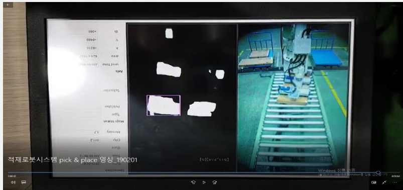
2차원 카메라 영상을 활용한 물체 형상 인식에 기반한 로봇 Pick & Place 작업
